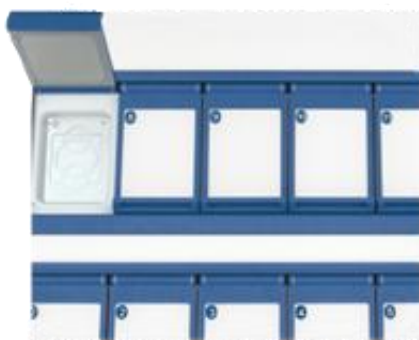
Kuva 21.1 Lämmityksenoptimointilevy MIRI® II-12-monitila-IVF-inkubaattorin kammiossa
