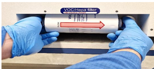
Kuva 12.2 VOC/HEPA-suodattimen asennus- ja poistomenettely
